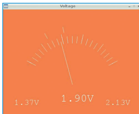
Figuur 4. Voltmeter met gesimuleerd wijzerinstrument en digitale weergave.
