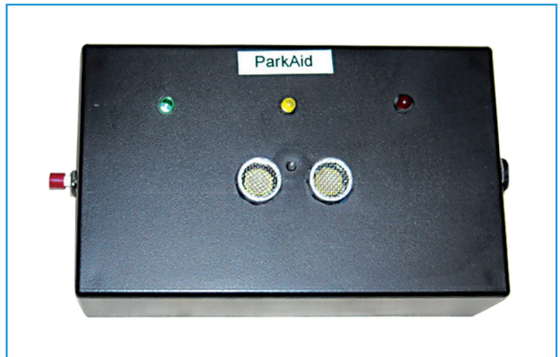
Figuur 2. De parkeerhulp van de auteur ziet er keurig uit in zijn behuizing.
