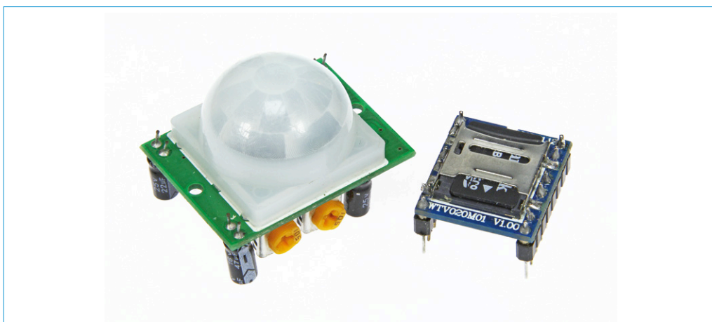
Figuur 2. De gebruikte geluidsmodule en PIR-sensormodule.
