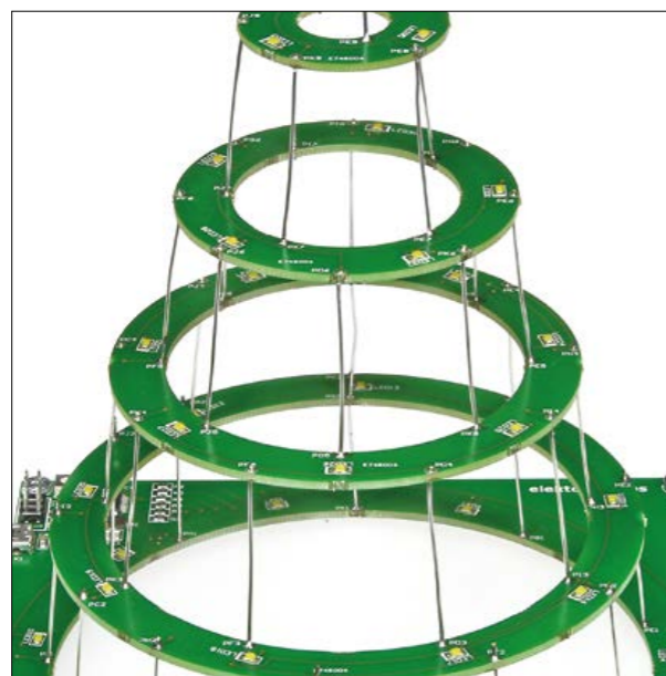
Figuur 4. De draadstukjes moeten zorgvuldig worden geplaatst en gesoldeerd, zodat de afstanden tussen de ringen overal hetzelfde zijn.
