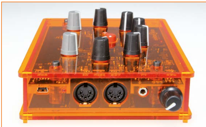
Figuur 6. De J 2 B-synthesizer in een plexiglazen behuizing, gemaakt met een lasersnijder.
